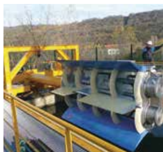
Une hydrolienne fluviale développée par HydroQuest mesurant entre 5 et 6 m de haut contre plus de 8 m pour ses concurrentes, à rendement égal.
