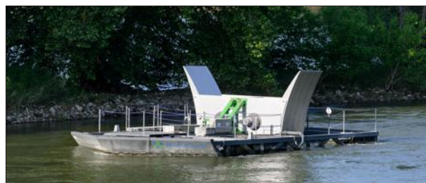
Les hydroliennes déployées fin 2018 en aval de Génissiat pourront être "relevées" (comme ici, à Orléans) pour être entretenues. Photo HydroQuest
