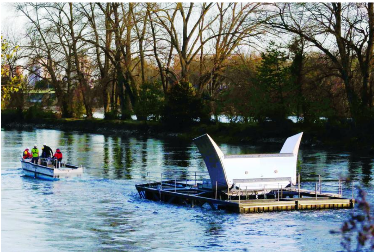
Hydroquest a installé la première ferme d'hydrolienne fluviale dans le Rhône. © Hydroquest
